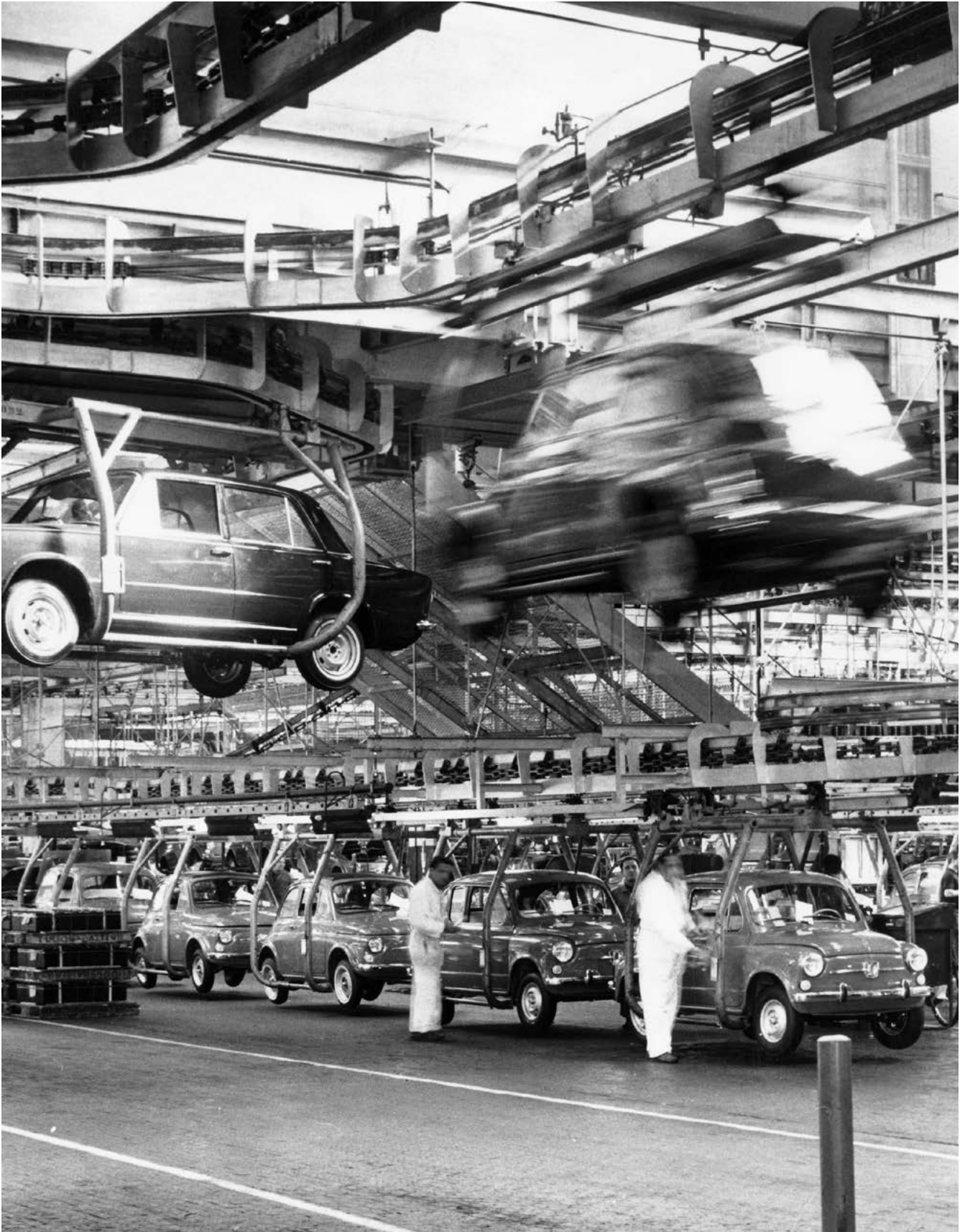
Fiat Mirafiori: convogliatori aerei per il trasporto carrozzerie, ca. 1960 – Foto archivio fotografico Touring Club Italiano
