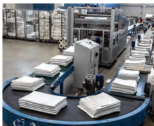
Foto 9 Nastri trasportatori tra piegatrice e imbustatrice
