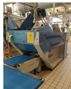
Foto 13 Macchina per piegatura e impacchettamento
