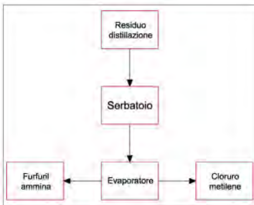
Figura 1. Schema a blocchi – recupero furfurilammina
