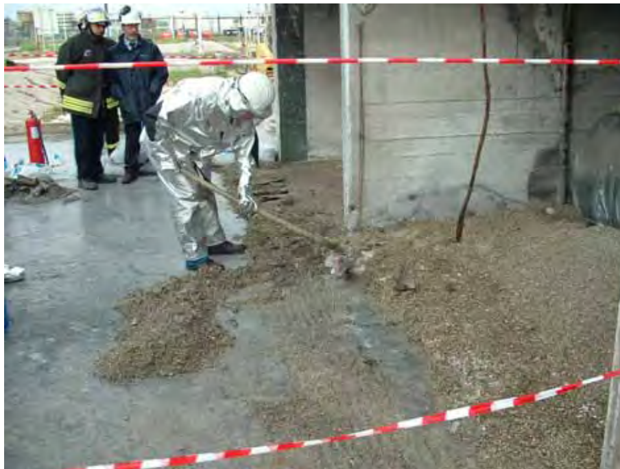
Foto n. 6 – Setacciatura della vermiculite; visibile in primo piano la canaletta riempita con prodotto assorbente
