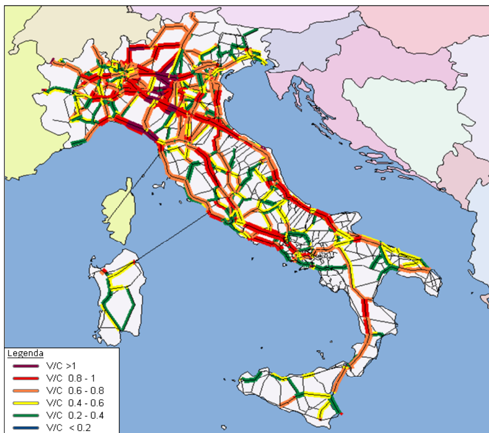
Criticità simulate sulla rete stradale al 2020 - Scenario medio
