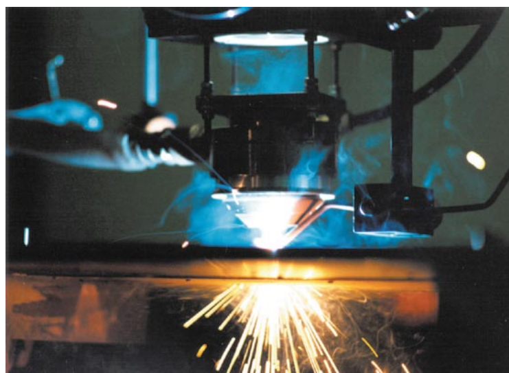
Formation of ultrafine particles when processing material with laser beam, BGIA – Institut für Arbeitsschutz der Deutschen Gesetzlichen Unfallversicherung, Germany.
