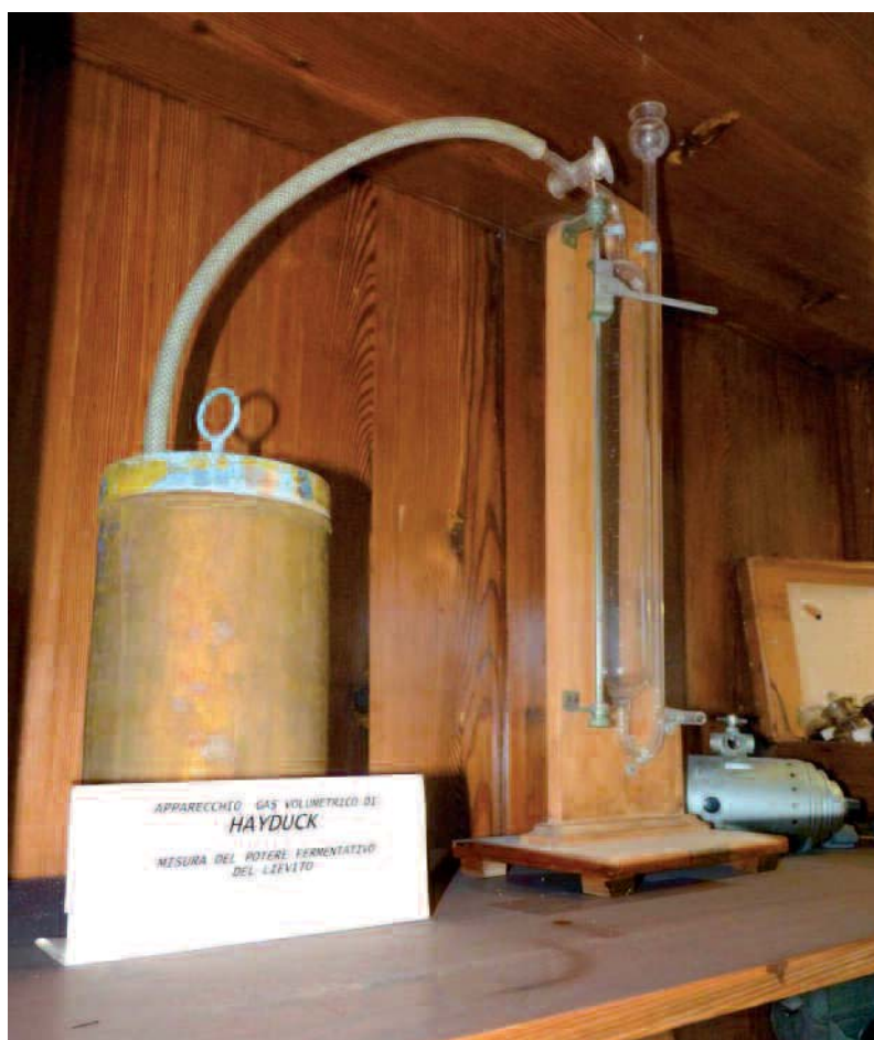
Apparecchio di Hayduck per la determinazione del potere lievitante (1968)
